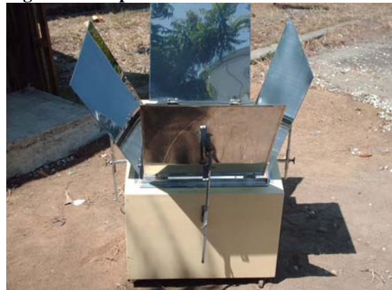
Figura 10. Prototipo con reflectores móviles.
